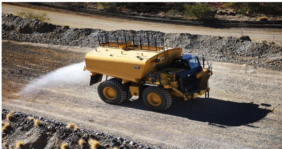
**Figura 21:** Camião Pipa Borrifador de Estrada de marca komatsu 777
