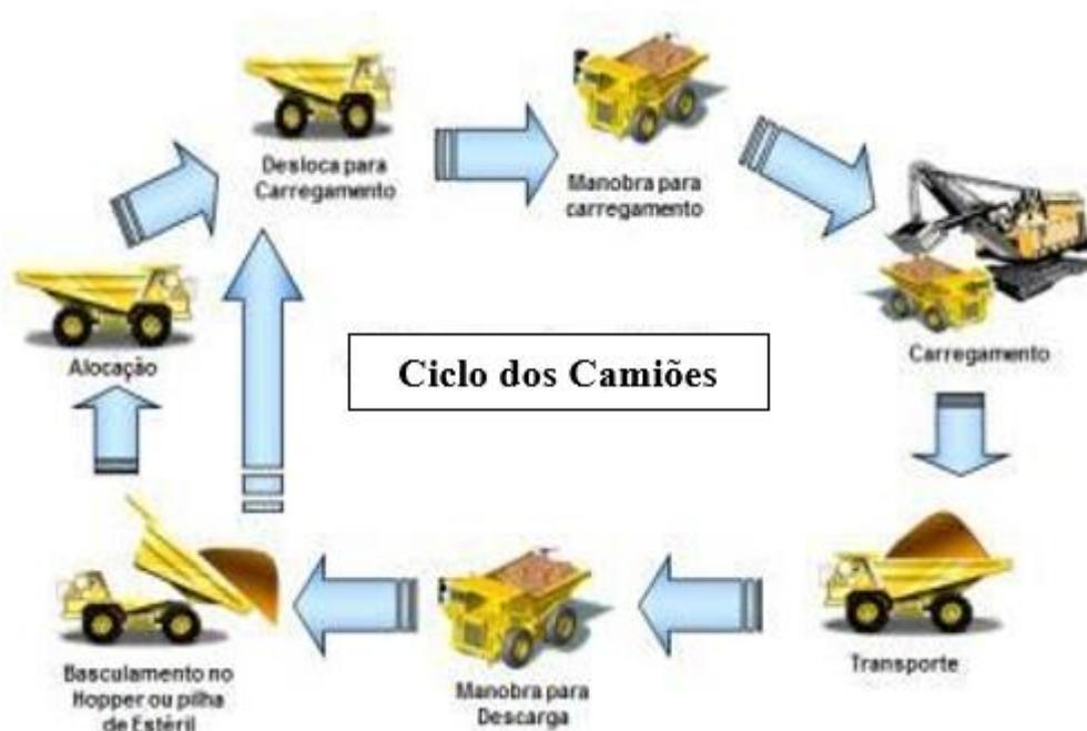
**Figura 4:** Ciclo de Operação de Carga e Transporte
